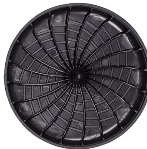
Асимметричная форма подвеса: обеспечивает более линейное движение купола, свободное от резонансов
